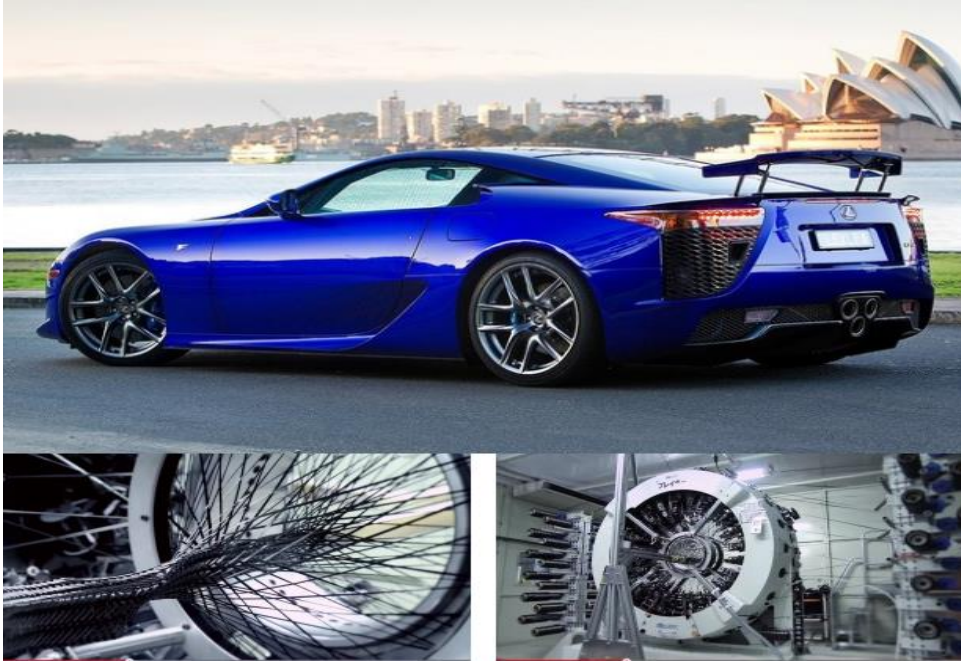
Şekil 3.6. Spor otomobil parçalarının karbon lifinden hazırlanması [55].
