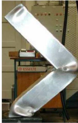
Şekil 3.3. Global burkulmaya uğramış profil görseli [1]
