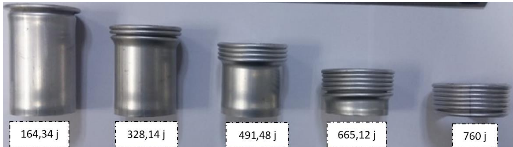
Şekil 6.3. Farklı ezilme miktarlarında 40 mm çaplı tüpün absorbe ettiği enerji ve oluşan deformasyon görüntüleri
