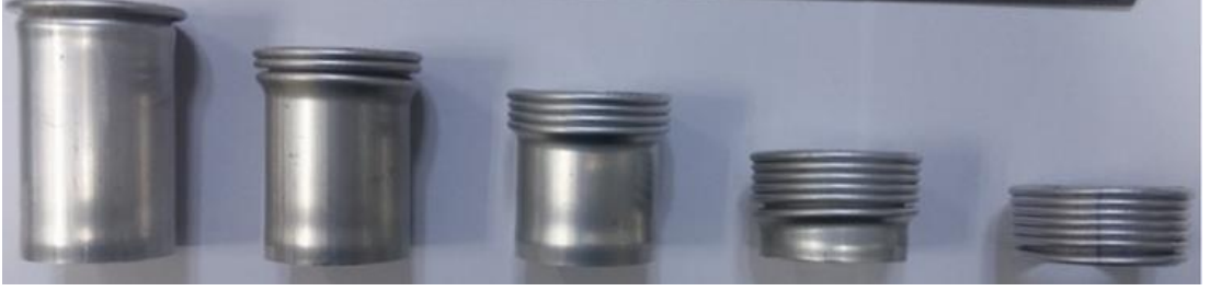
Şekil 3.2. Homojen lokal burkulma gözlenen bir ezilme kutusu [7]
