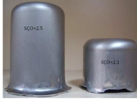
Şekil 2.12. Halkacı ve ark. (2012) çalışmasında AA 5754'ün klasik derin çekmede 2.1 olan SÇO değeri HMDÇ prosesiyle 2.5 değerine yükseltilmiştir
