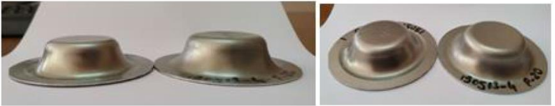
Şekil 4.14. Presto ÇTHŞ prosesiyle üretilen ilk parçalar
