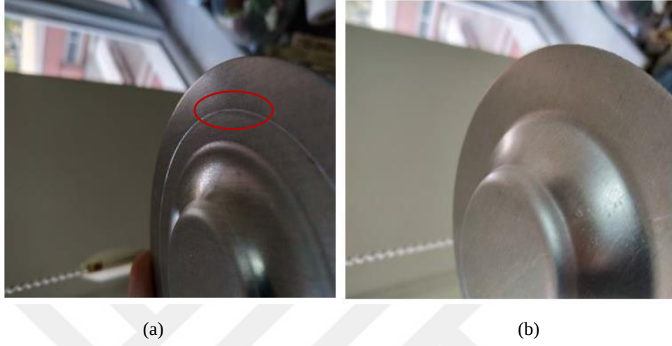
Şekil 4.15. Sızdırmazlık kademesinin keskin kenarlı olması durumunda sacda oluşan etki
