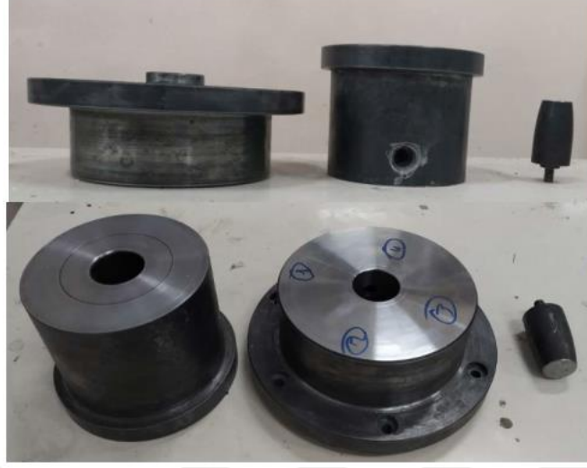
Şekil 3.5. Endüstriyel iş parçasının ÇTHŞ ile imal edilebilmesi için gerekli üst kalıp, alt kalıp ve ıstampa
