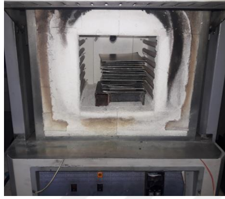
Şekil 3.30. Tavlamaya tabi tutulan numuneler ve ısıl işlem fırını
