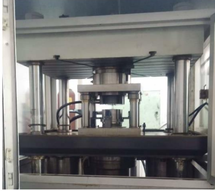
Şekil 3.53. Modifikasyonu gerçekleştirilen deney presi
