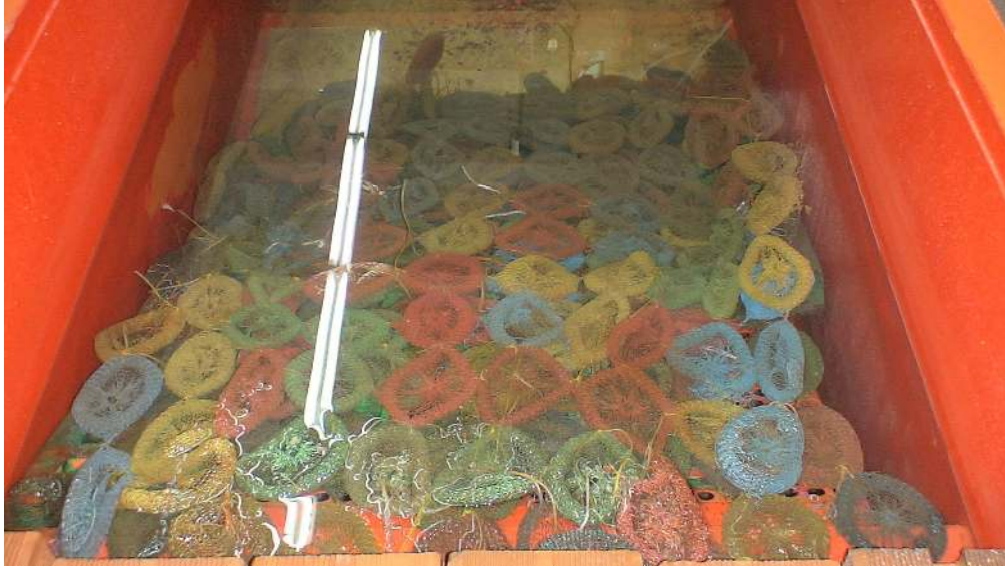
Şekil 4.5 Dalga üreticinin arkasındaki dalga sönümlendiricileri
