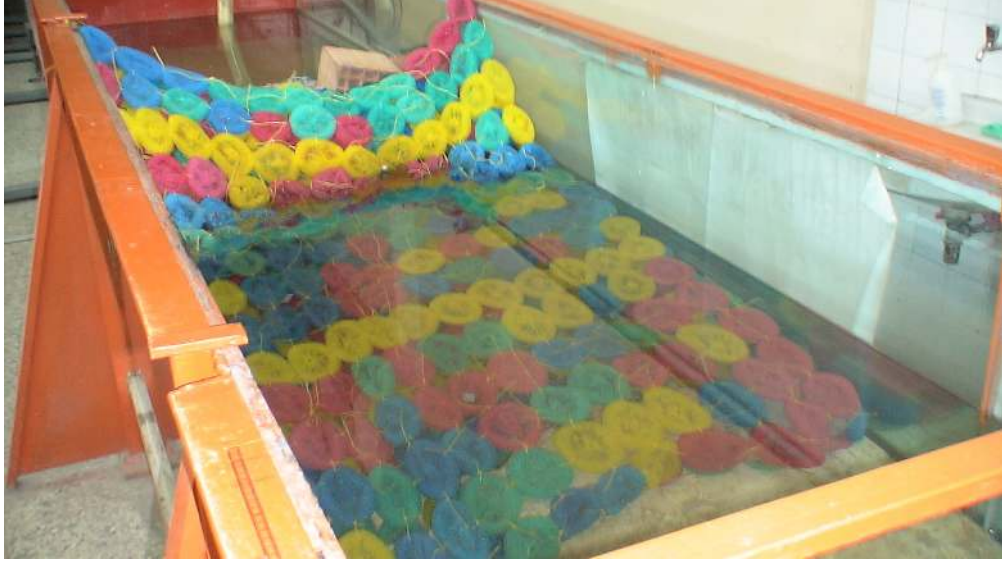
Şekil 4.4 Şev üzerindeki dalga sönümlendiricileri
