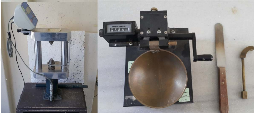
Şekil 4.18. Sırasıyla Koni Düşürme ve Çarpmalı Cihaz Deney Düzenekleri.
