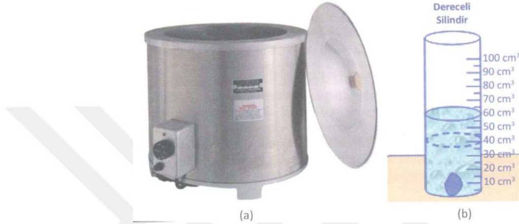
Şekil 4.15. (a) Erimiş Parafin Kabı (b) Cam Silindirde Su Taşıma Yöntemi (Laman vd., 2016).
