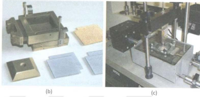
Şekil 4.22. (a) Kesme Kutusu Deney Düzeneği (Uzuner, 2014), (b) Direkt Kesme Kutusu, Poroz Taşlar Ve Yükleme Başlığı, (c) Düşey Ve Yanal Yük Ölçümleri İçin Yük Sensörü Kullanılan Bir Direkt Kesme Deney Düzeneğinden Görüntü (Laman vd., 2016).
