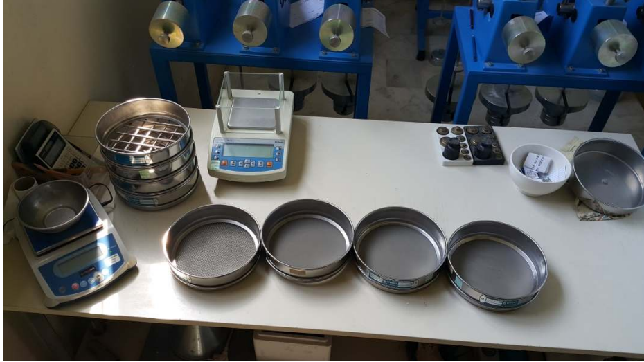
Şekil 4.11. Elek Analiz Düzenegi.
