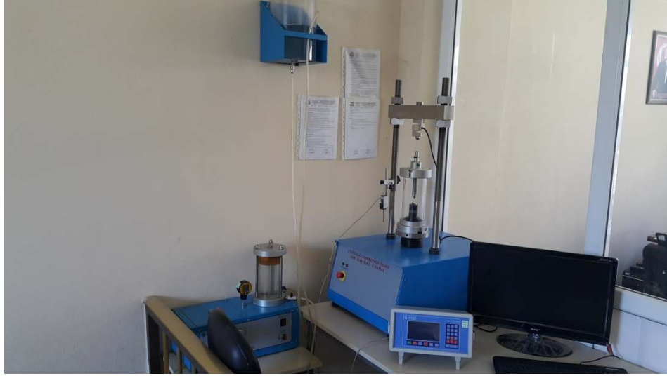
Şekil 4.23. Üç Eksenli Basınç Deney Düzeneği.
