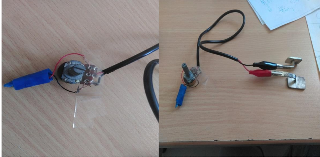
Şekil 3.5. Mavi bant içine sabitlenmiş saat pili, potansiyometre, iletken kısıkaçlar ve gümüş plakalar düzeneği.
