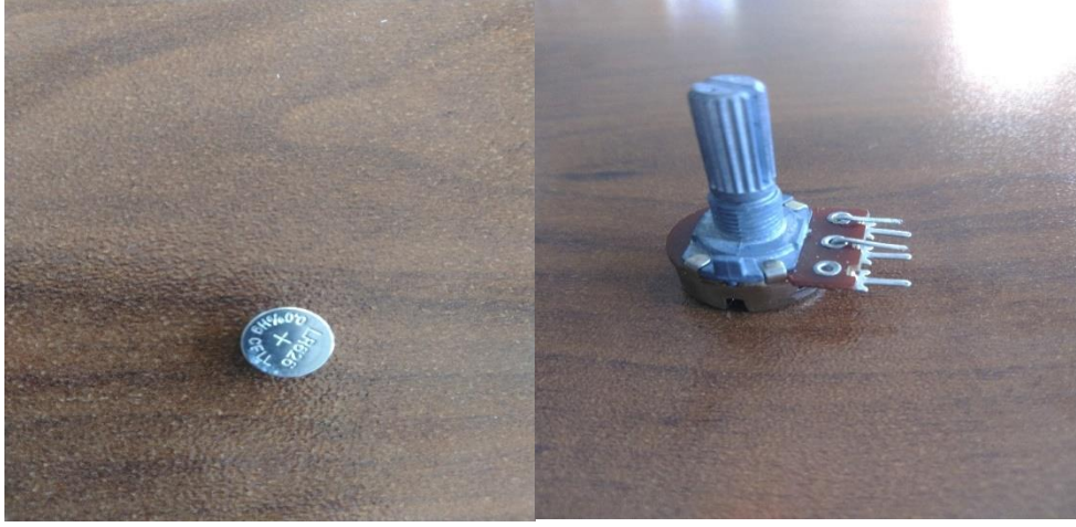
Şekil 3.4. 1.5 Volt' luk saat pili (solda), 5 MΩ' luk potansiyometre (sağda).
