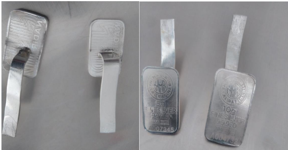
Şekil 3.2. Gümüş plakaların saplarının kalıplanmış ve plakaya işlenmiş hali.
