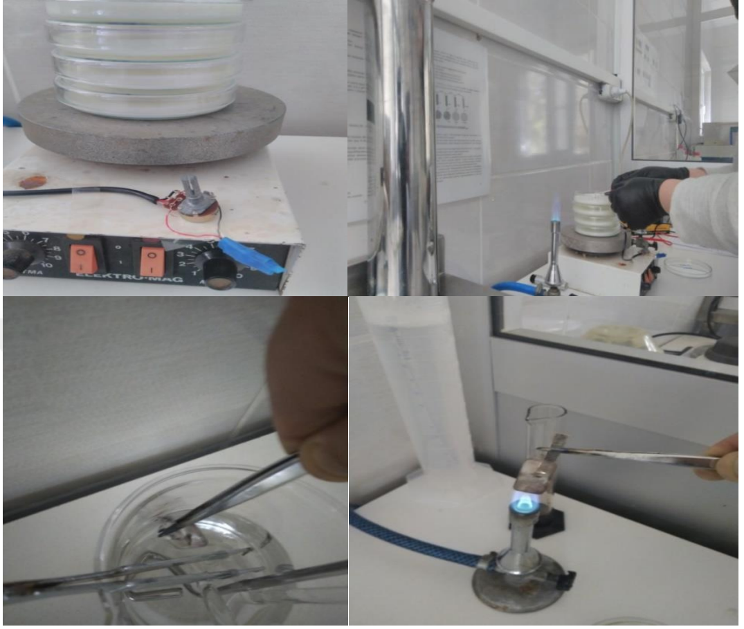
Şekil 4.13. Ayarlaması yapılan gümüş anot düzeneginin bek alevleri arasındaki platforma sabitlenmesi (üstte solda), çalışmanın yapılması (üstte sağda), desenler arası alkolde bekletilen gümüş plakalar (altta solda) ve alkolden alınan gümüş plakaların alevden geçirilerek sterilize edilmesi (altta sağda).
