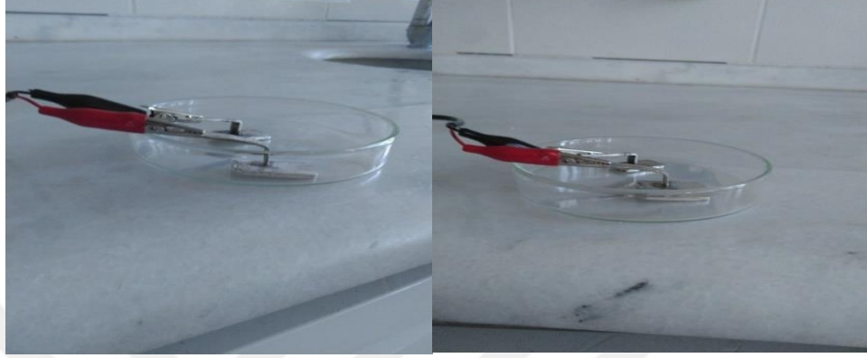
Şekil 3.3. Gümüş anot plakalarının petri kabına yerleştirilmiş pozisyonu.
