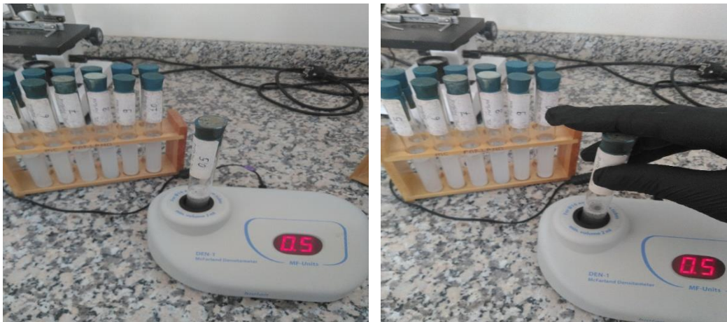
Şekil 4.3. Hazırlanan Mc Farland bulanıklık standartlarının densitometre ile doğrulanması.
