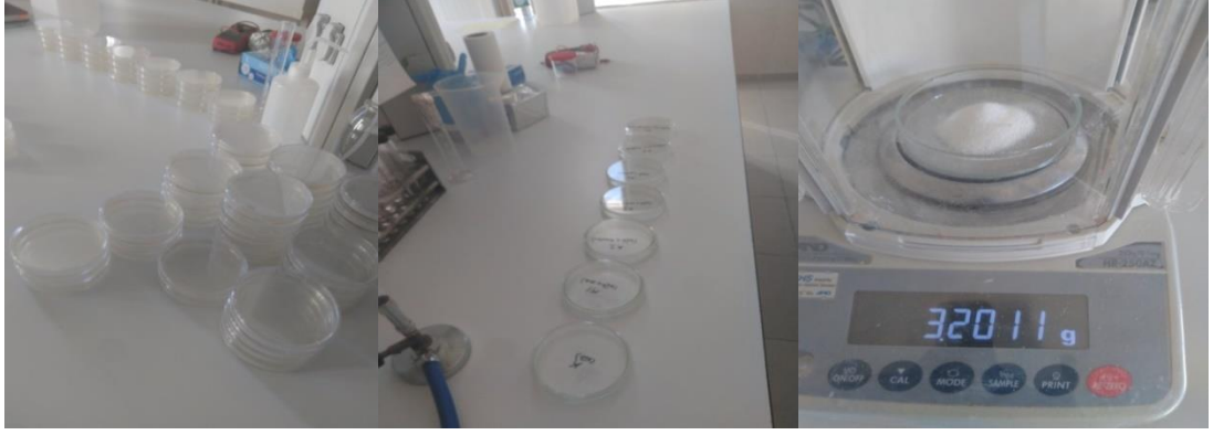
Şekil 4.14. Petri kaplarına CA besiyerinin dökülmesi (sağda), uygulama desenlerinin cam petri kaplarına yazılması (ortada), lizozim içeren desenlerin petri kaplarına lizozim enziminin tartılması (sağda).
