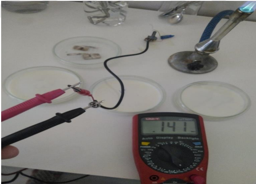
Şekil 4.12. Potansiyometrenin, avometre kontrolünde, hesaplanan \text{M}\Omega seviyesine ayarlanması.
