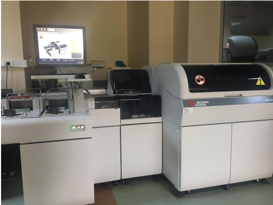
Şekil 3.3. Beckman Coulter AU5800 model kolesterol ölçüm cihazı
