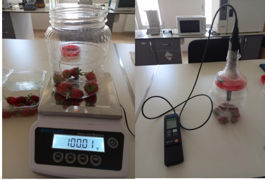
Fotoğraf 3.3. Testo 535 CO2 ölçüm cihazı ile solunum ölçümü.
