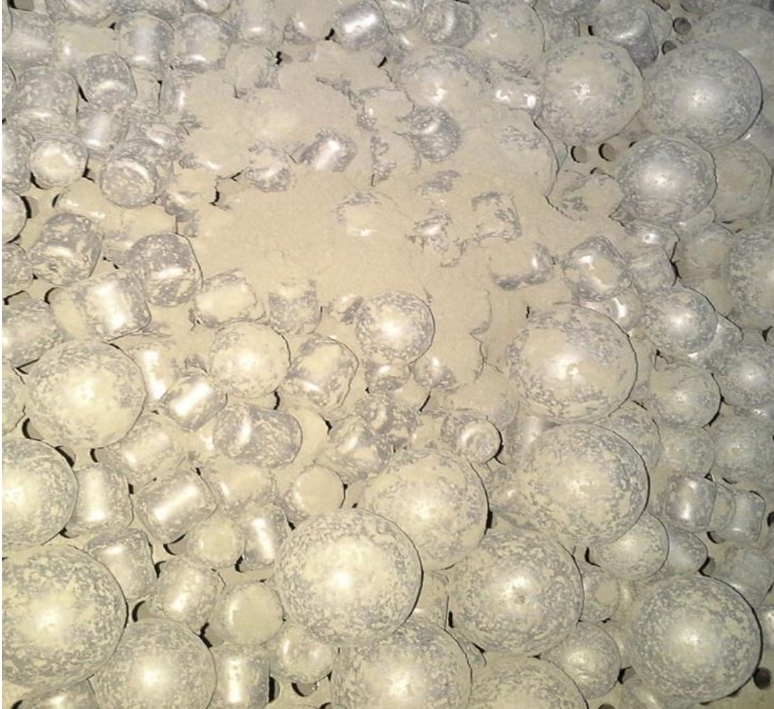
Şekil 2.1. Öğütme yardımcısı kullanılmadan öğütme medyasının (bilyelerin) çimento ile kaplanması.
