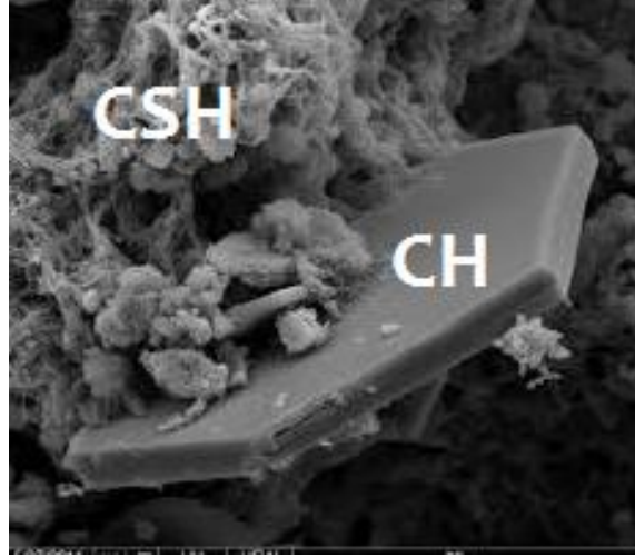
Şekil 1.2. Taramalı elektron mikroskopunda 10000 kat büyütülmüş çimento hamuru içindeki CH kristalleri ve C-S-H jelleri (Franus ve ark., 2015).
