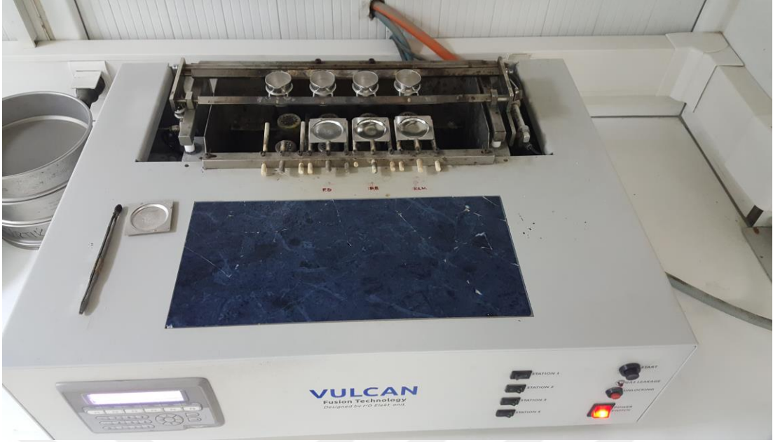
Şekil 3.10. Otomatik füzyon (eritiş) cihazı, Pt-Ag füzyon kabı ve kalıbı, hazırlanmış eritiş numune.
