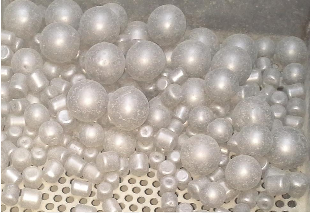
Şekil 2.2. Öğütme yardımcısı kullanılan öğütme medyasının (bilyelerinin) temiz kalması ve verimlilik artışı.
