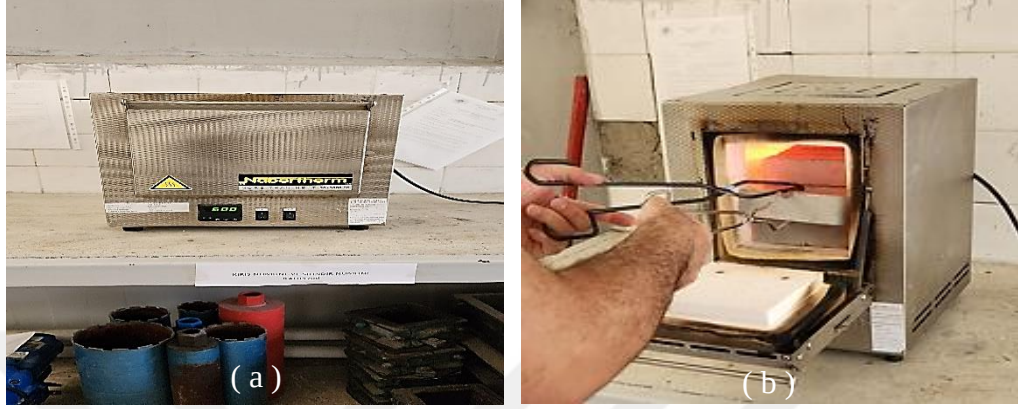
Şekil 3.11. a) Numunelerin yüksek sıcaklığa maruz bırakıldığı fırın b) Numunelerin fırına konması
