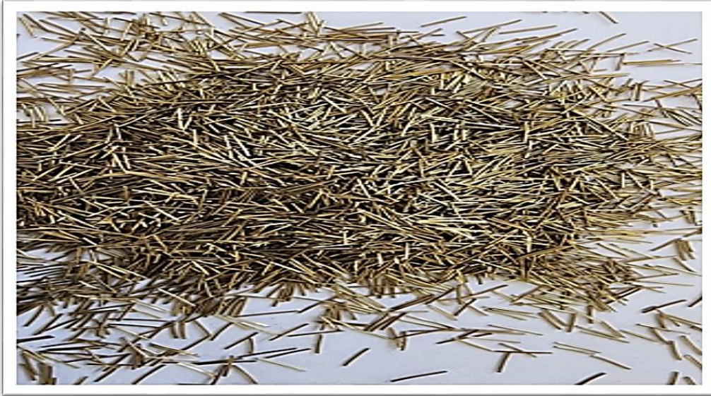
Şekil 3.3. Deney esnasında kullanılan ve 35 mikron çapa sahip pirinç kaplı çelik life ait görsel
