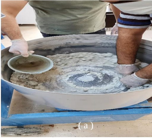
Şekil 3.7. a) Malzemelerin karışım mikserine konması b) Numunelerin karışım mikserinde karıştırılması işlemi
