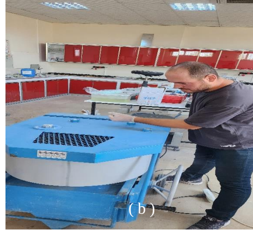
Şekil 3.7. a) Malzemelerin karışım mikserine konması b) Numunelerin karışım mikserinde karıştırılması işlemi
