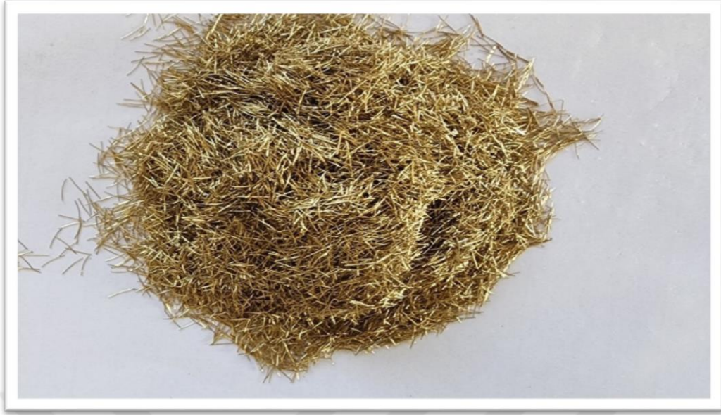
Şekil 3.2. Deney esnasında kullanılan ve 16 mikron çapa sahip pirinç kaplı çelik life ait görsel
