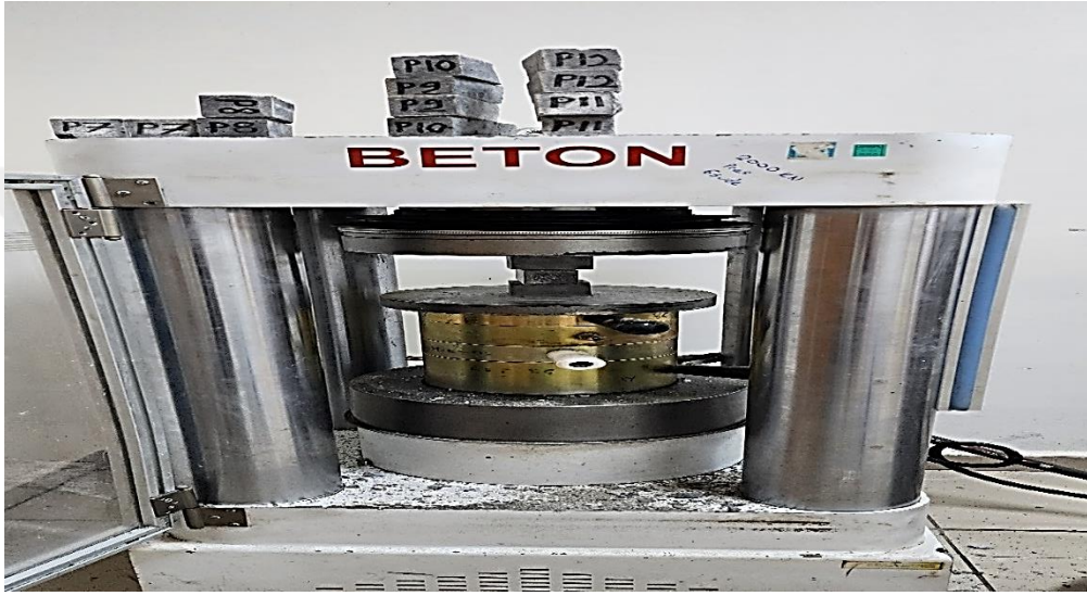
Şekil 3.14. Basınç dayanımı test düzeneği
