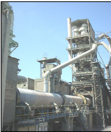
Şekil 6.6 Tesisteki sırasıyla üç döner fırın Akçansa A.Ş.
