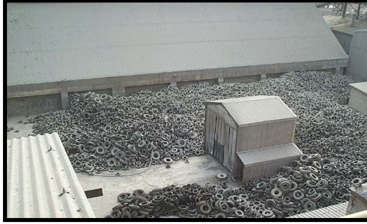
Şekil 3.1 Çimento fabrikasında atık lastiklerin depolanışı (Akçansa A.Ş)
