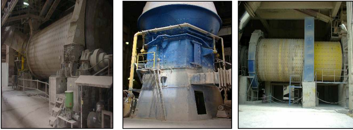
Şekil 6.3 Sırayla 1, 2 ve 3 nolu farin öğütücüler Akçansa A.Ş.
