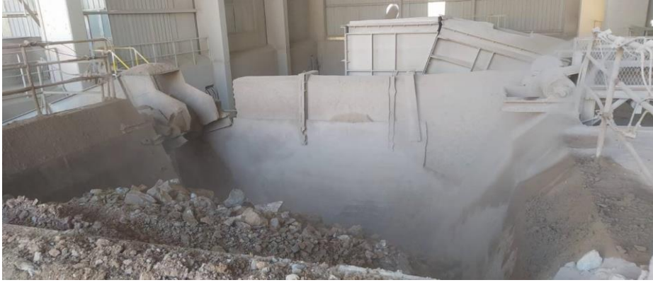
Şekil 4. Kalker kırıcı bunkerı
