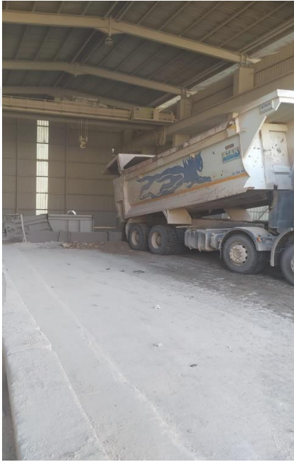
Şekil 5. Kalkerin kırıcı bunkerine hammadde dökmesi
