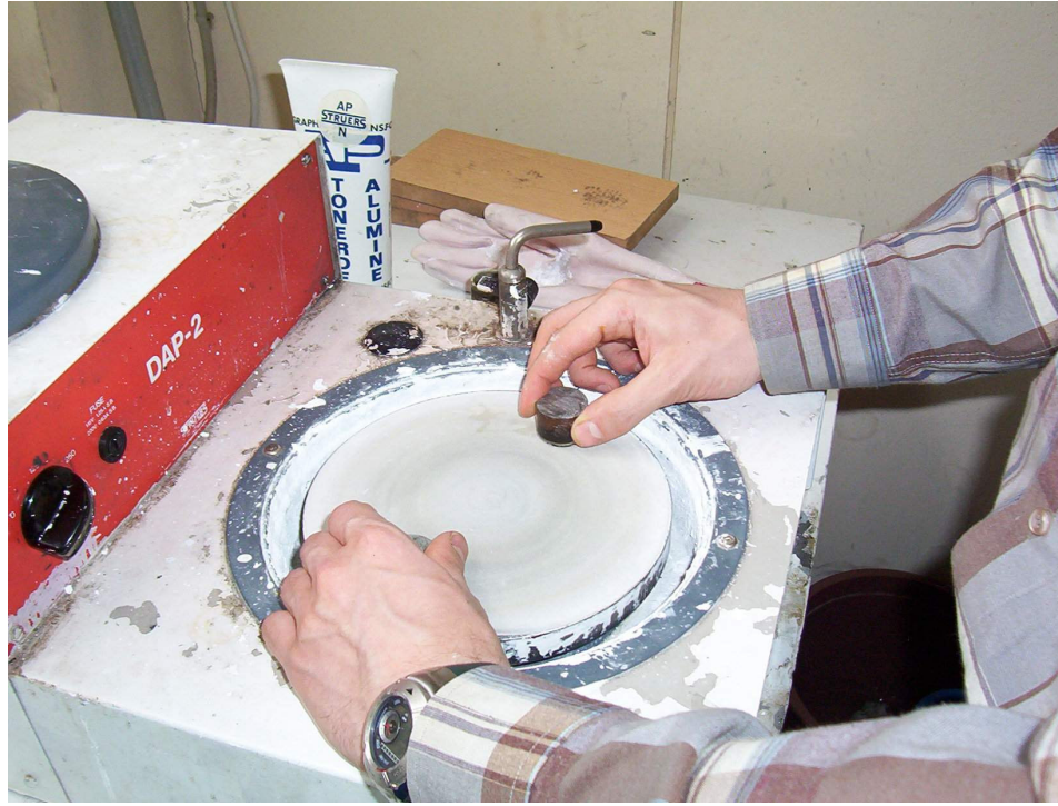
Şekil 4.2 Elmas pasta ile yüzey parlatma işlemi
