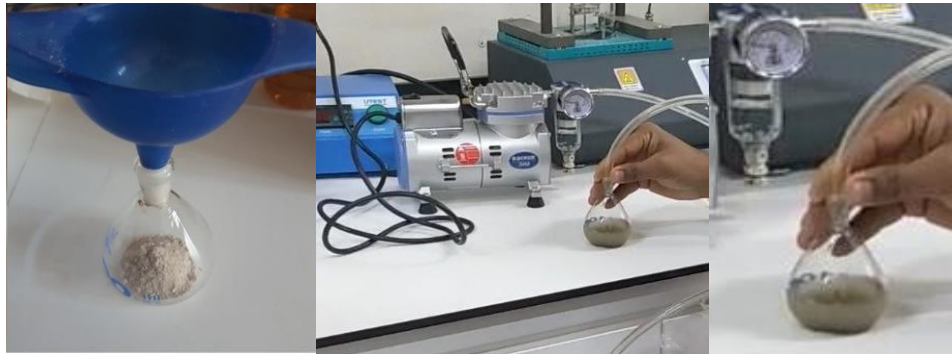
Şekil 4.7: Piknometre deney aşamaları
