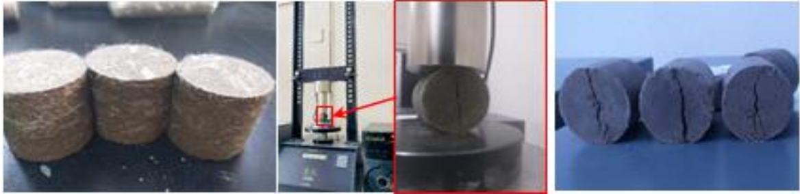
Şekil 4.10: Dolaylı çekme dayanımı deneyi uygulanması
