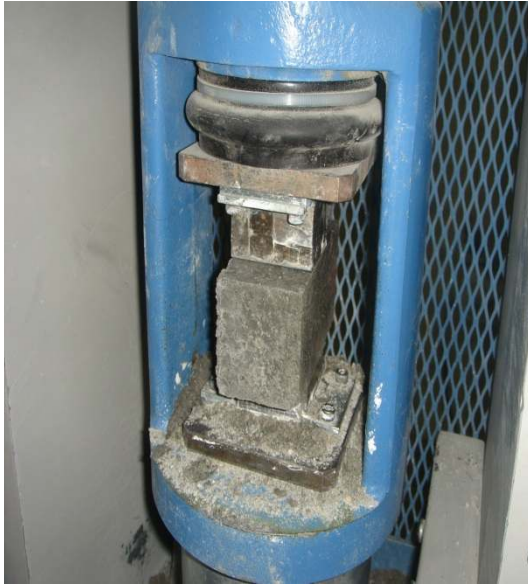
Resim 1.18. Harç numunelerine basınç deneyi uygulanması
