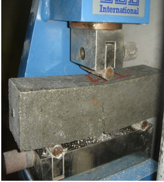
Resim 1.17. Harç numunelerine eğilmede çekme deneyi uygulanması
