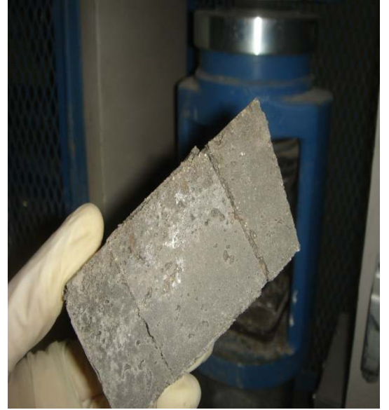
Resim 1.18. Harç numunelerine basınç deneyi uygulanması
