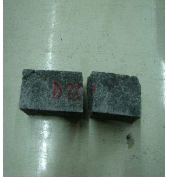
Resim 1.17. Harç numunelerine eğilmede çekme deneyi uygulanması
