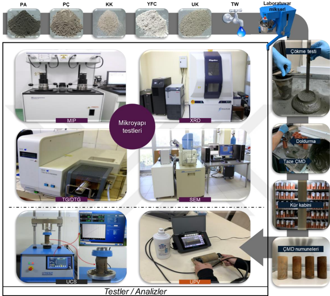
Şekil 25. ÇMD numunelerinin hazırlanması ve test aşamaları
