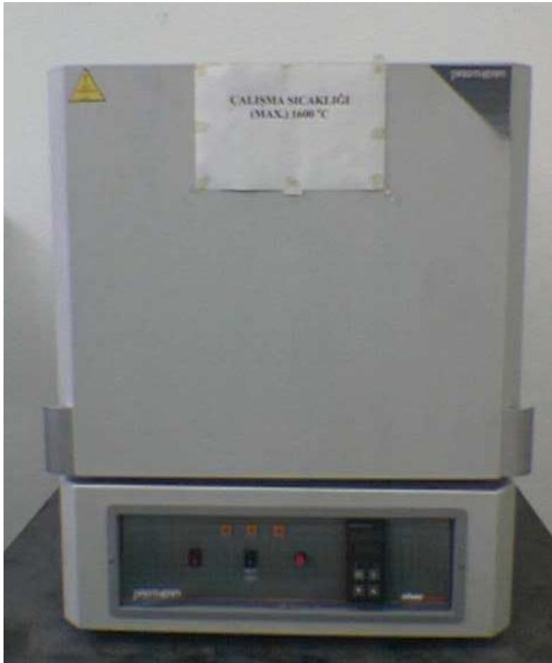
Şekil 6.2. Sinter ve yaşlandırma ısıtma işlemi yapılan fırın
