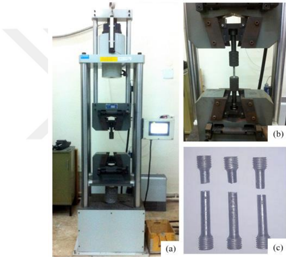
Şekil 19. Çekme deneyi, a) Alşa marka çekme deney cihazı, b) Çekme deney numunesinin bağlanması, c) Deney sonucunda kırılan numuneler.
