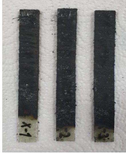
Şekil 5.11. Çinko Borat katkısı eklenmemiş numunelerin yanma sonrası görüntüsü
