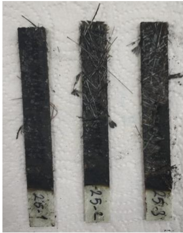
Şekil 5.15. %25 Çinko Borat katkısı eklenmiş numunelerin yanma sonrası görüntüsü
