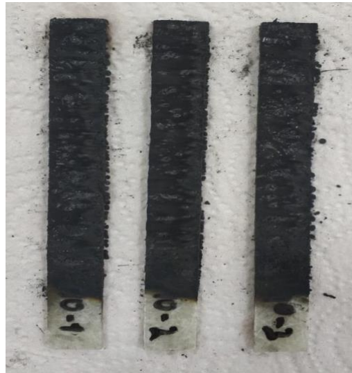
Şekil 5.12. %10 Çinko Borat katkısı eklenmiş numunelerin yanma sonrası görüntüsü
