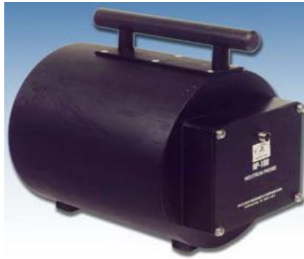
Şekil 2.9: Deneyde kullanılan Canberra NP100B nötron dedektörü.
