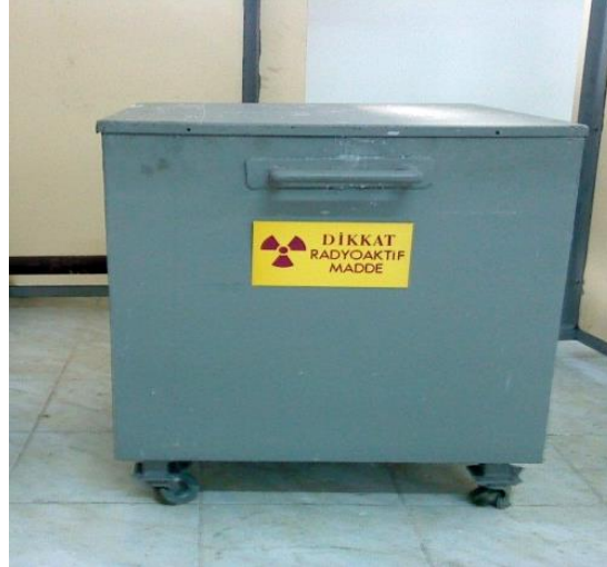
Şekil 2.10: Ölçümlerde kullanılan nötron kaynağı (Parafin ve kurşun koruma içinde)[57].
