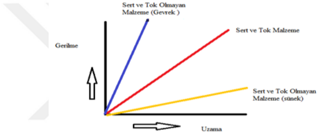
Şekil 1.12: Gevrek ve sünek malzemeler için gerilme/uzama grafiği.
