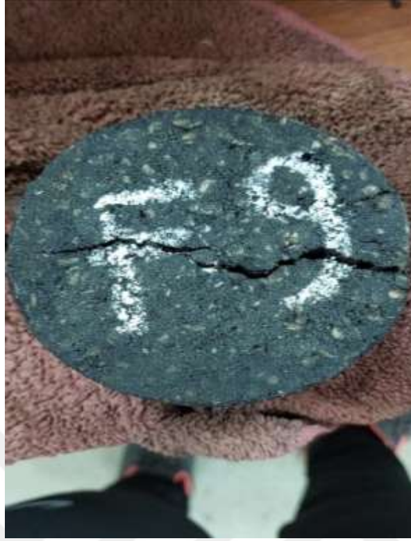
Şekil 39. Çatlama deneyi sonrası örnek numune
