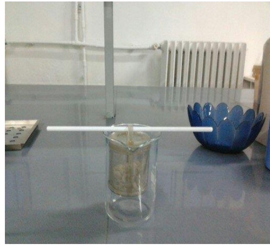
Şekil 7.3 Fotokatalitik ZnO doplanmış nano boyutlu \text{TiO}_2 ile kaplanmış seramik boncuklar
