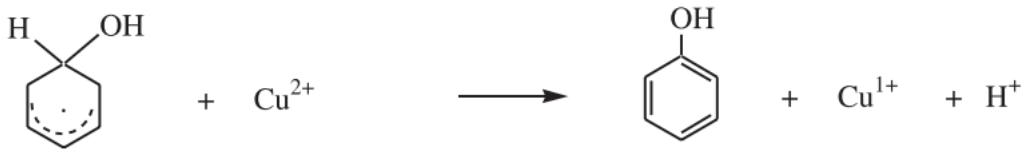
Şekil 2.19: Benzenin oksidasyon reaksiyonu için öngörülen mekanizma (Kitamura ve diğ. 2004).
