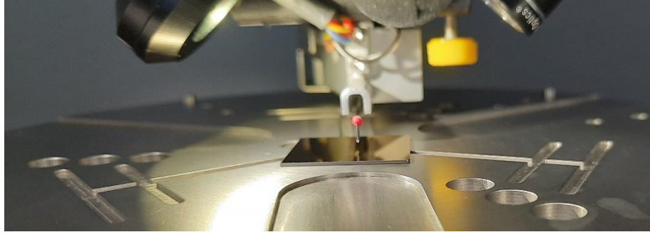
Görsel 4.1. Bruker DEKTAK XT ölçüm görseli
