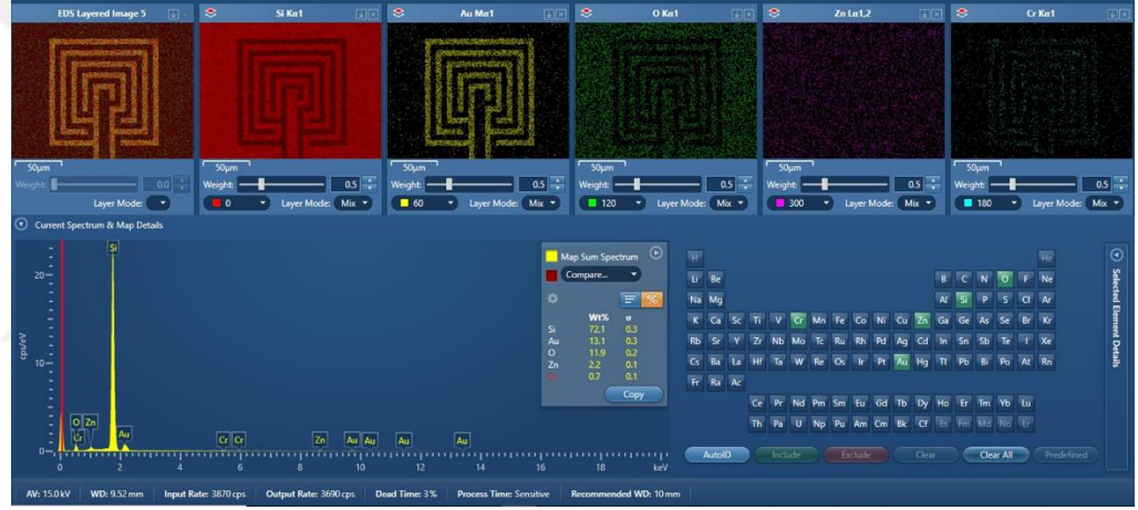
Görsel 5.26. Sensör kare yapıların EDS analizi
