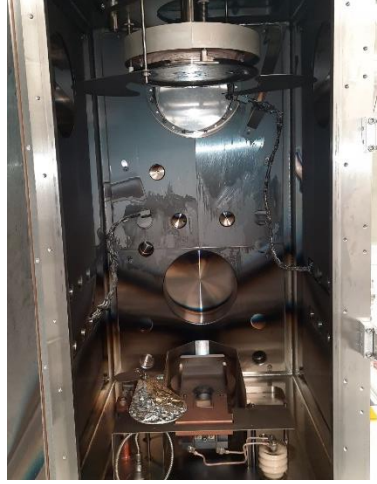
Görsel 5.19. E-Beam evaporasyon sisteminde numunelerin yerleştirilme görseli
