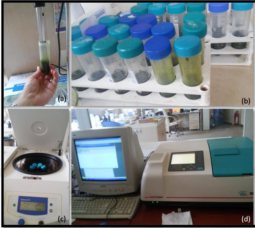
Şekil 3.7. Spektrofotometrede klorofil analizlerinin yapım aşamaları a) yaprak püresinin homojenizasyonu b) örneklerin aseton ile 25 ml'e tamamlanması c) örneklerin santrifüj edilmesi d) süzüntülerin absorpsiyonlarının spektrofotometrede okutulması
