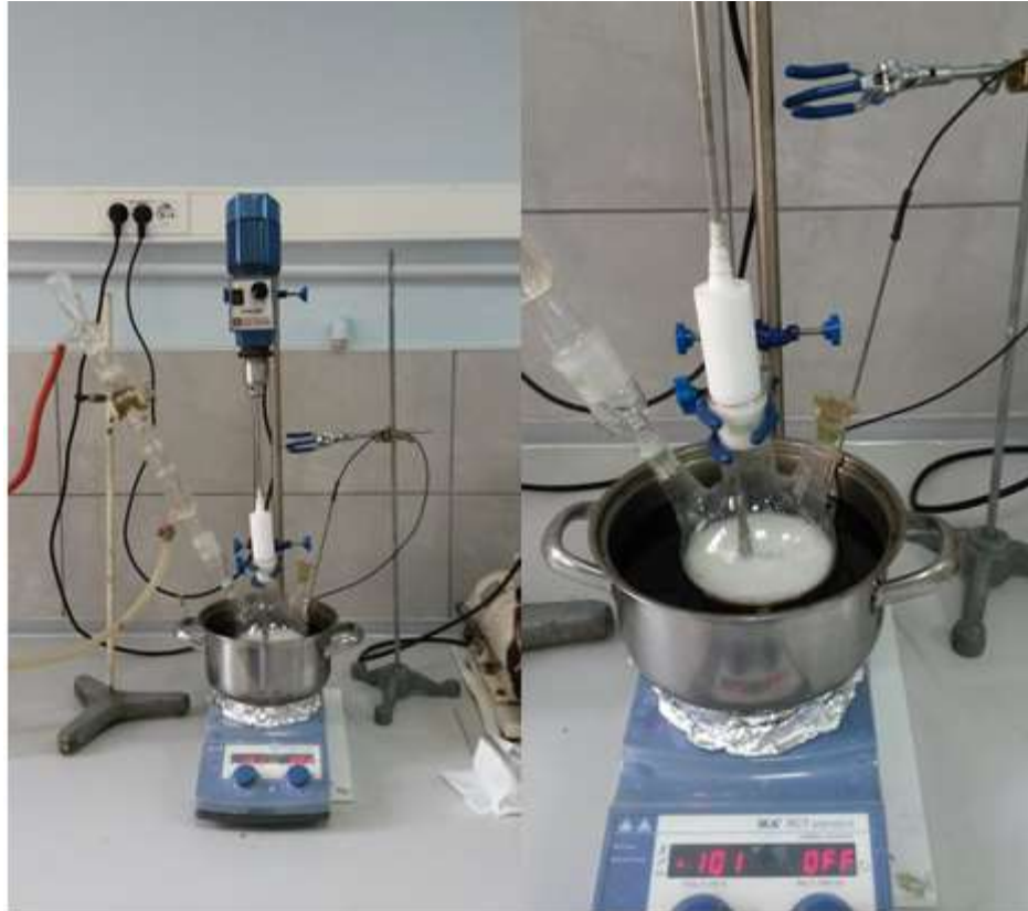
Şekil 7.13 : Bentonitin asitle modifikasyonu deney düzeneği.
