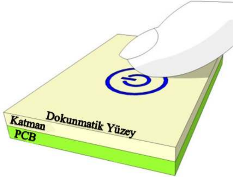
Şekil 3.1. Kapasitif sensör uygulaması
