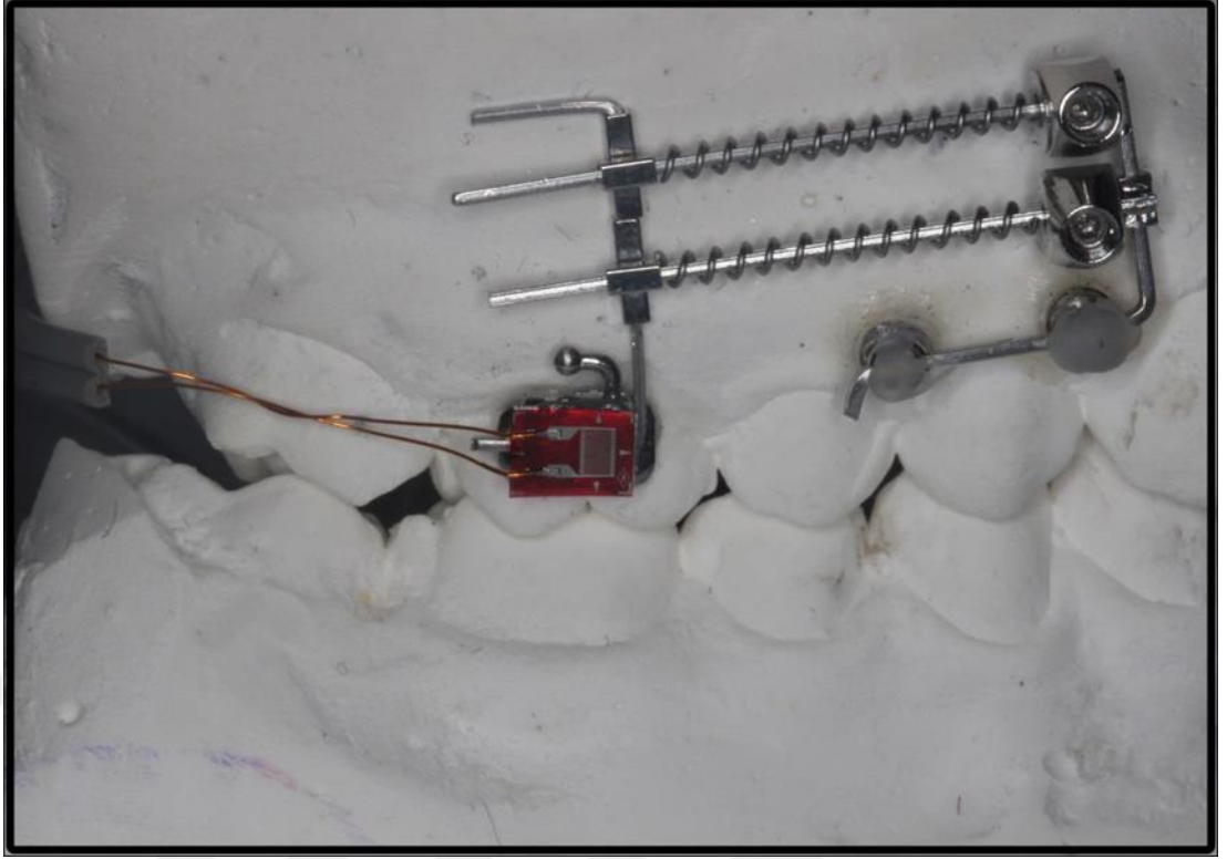
Şekil 5: Molar tüpü üzerine strain gauge yerleşimi
