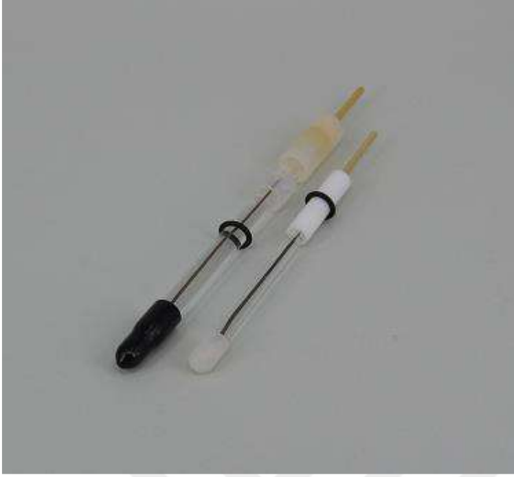
Resim 3.1. Referans elektrot, Ag/AgCl (Doygun KCl)
