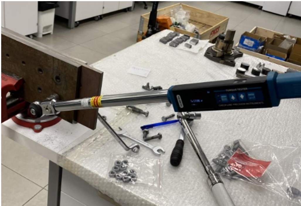
Şekil 2.11 Tork anahtarının test dzeneğ zerinde kullanılması
