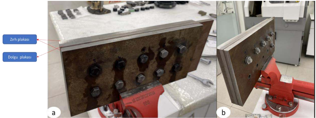
Şekil 2.10 15330 Standardına gre oluřturulmuř test dzeneğinin nden grnm (a) arkadan grnm (b)
