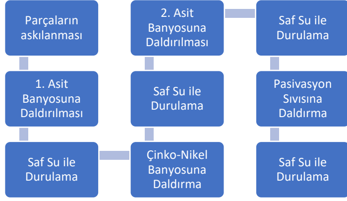
Şekil 2.4 Kaplama Banyosu Akış Şeması
