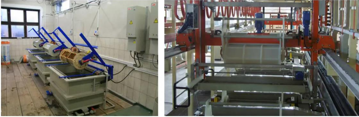
Şekil 1.4 Tambur ile kaplama havuzuna daldırma işlemi [7]
