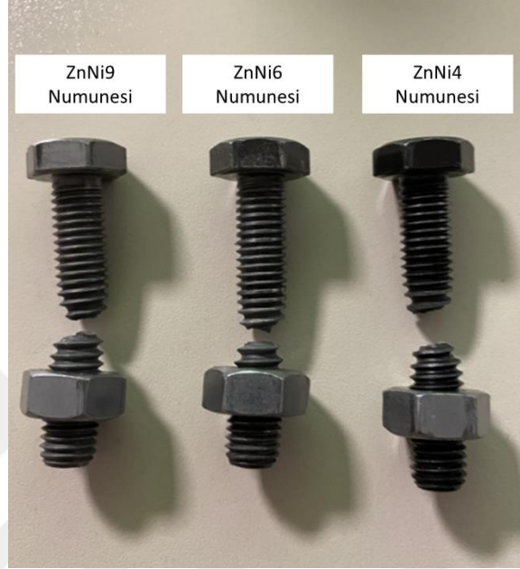
Şekil 3.6 Tork testinden sonra ZnNi9, ZnNi6 ve ZnNi4'nin gösterimi
