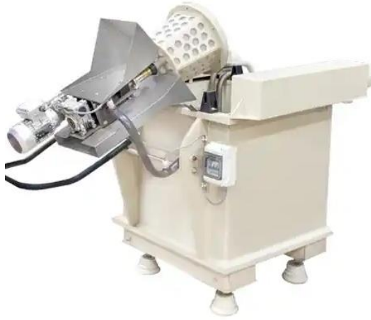
Şekil 1.5. Bell kaplama banyosu [7]
