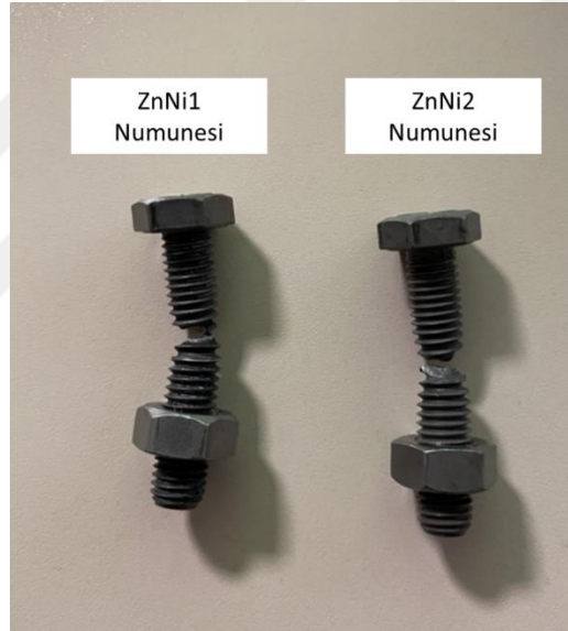
Şekil 3.5 Tork testinden sonra ZnNi1 numunesi
