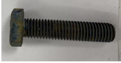
Şekil 3.3 0,5 Amp/dm 2 ile kaplanan ZnNi10 numunesi
