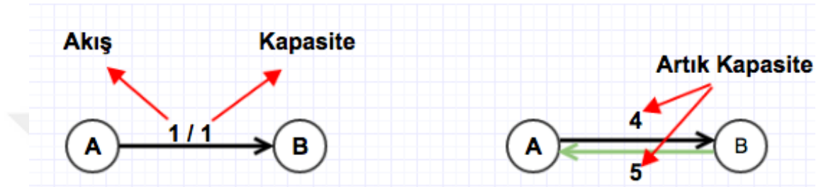
Şekil 2.3. Çizge ve artık çizgedeki akış ve kapasite gösterimi
