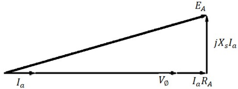
ekil 2.12. Omik bir yk besleyen senkron generatrn fazr diyagramı (Orijinal)
