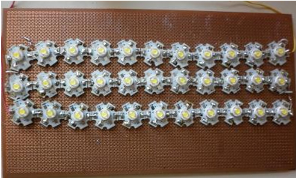
Şekil 3.12. LED modülünün yapısı
