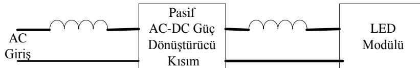
Şekil 2.6. Pasif LED sürücü devre şeması
