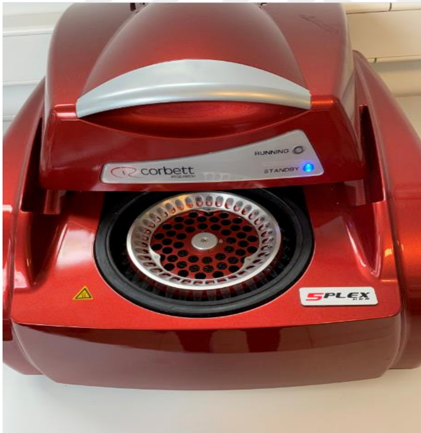
Resim 7. Corbett Research RG-6000 Real Time PCR (QIAGEN) cihazı
