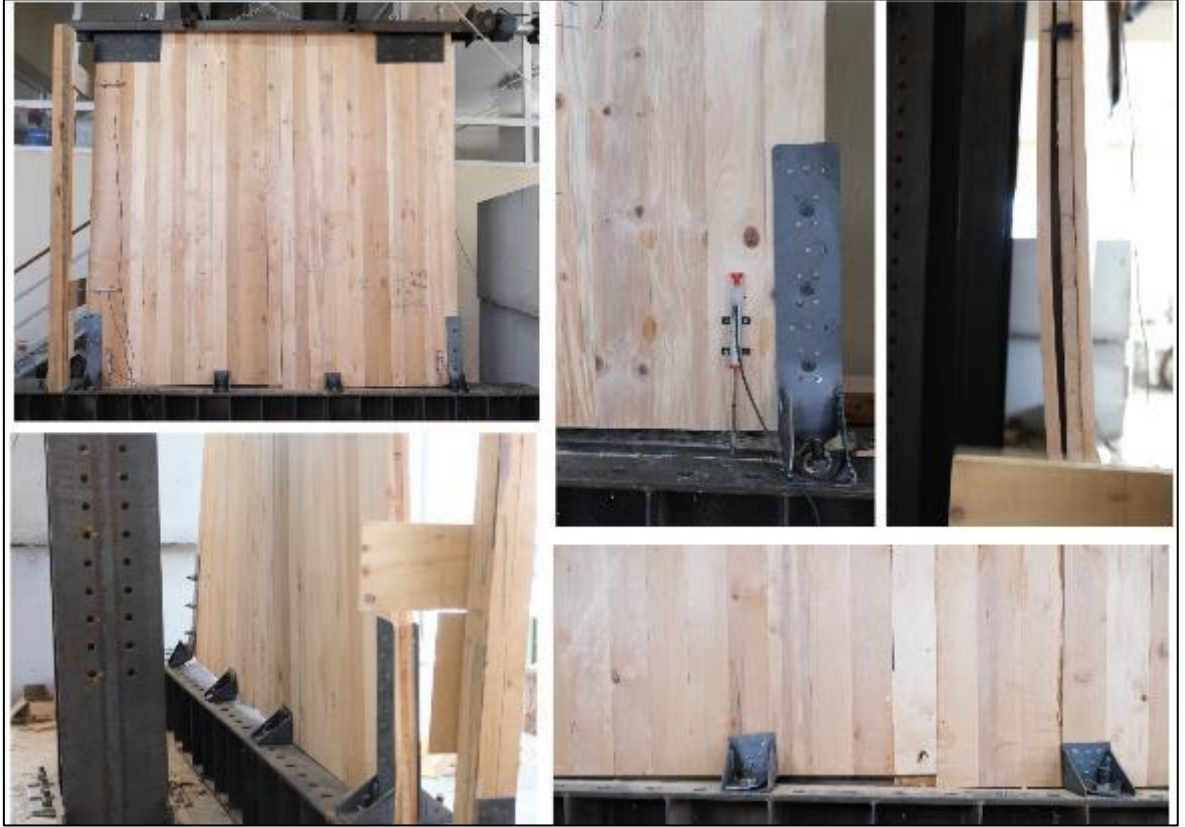
Şekil 43. Yanal yük testine maruz kalan CLT duvarların tüm gruplarında en sık rastlanan hasarlar
