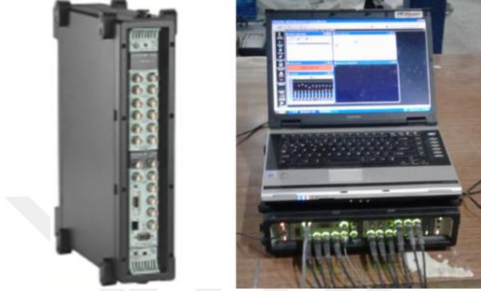
Şekil 18. B&K 3560 C tipi 17 kanallı veri toplama ünitesi
