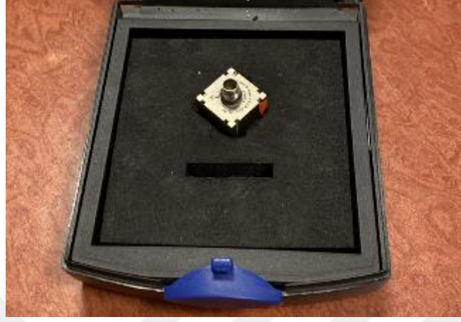
Şekil 17. B&K 4506 tipi üç eksenli ivme ölçer
