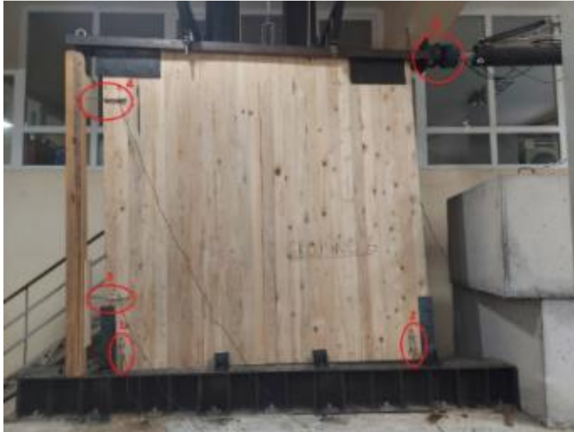
Şekil 15. LVDT'lerin yerleştirildiği düğüm noktaları
