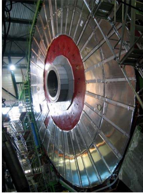
Şekil 2.34. (Yukarıda) CMS'deki çift aralıklı DPO'ların çalışma ilkesi, (Aşağıda) Kurulumdan sonra DPO'nun görüntüsü. Kırmızı renkteki demir boyunduruktur. (CMS-TDR-016, 2017)
