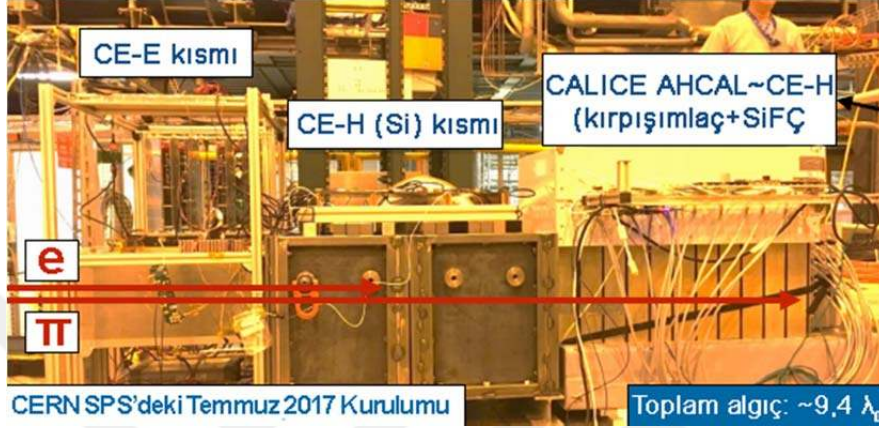
Şekil 4.11. CERN'de 2017 yılının Temmuz ayında kurulan demet testi düzeneği (Quast, 2017)
