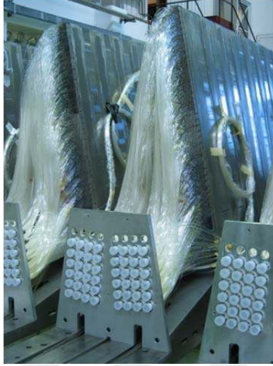
Şekil 2.27. Kuvars liflerle donatılan HF tablalarının genel görünümü ( http://cds.cern.ch/record/946271/files/oreach-2005-012.jpg )
