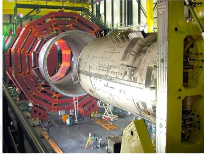
Şekil 2.35. Bobinin vakum tankına yerleştirilme denemesi ( http://cds.cern.ch/record/43055/files/magnet-2002-021.jpg )
