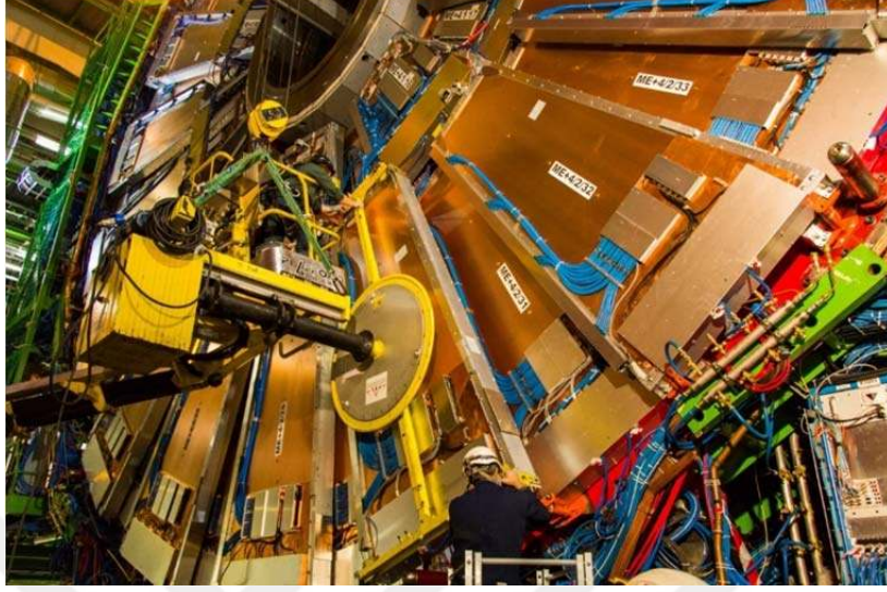
Şekil 2.33. ME4/2 odasının kurulumu (CMS-TDR-016, 2017)
