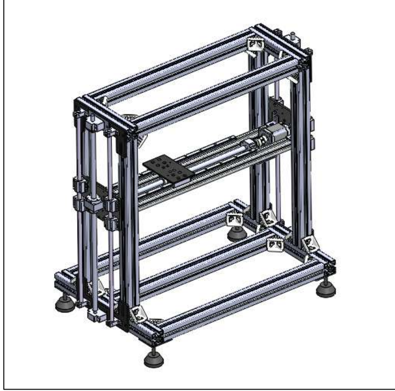
Şekil 3.10. X, Y eksenleri ve taşıyıcı gövdesi tasarımı.
