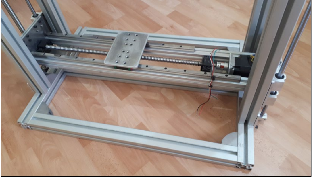
Şekil 5.24. X eksenli step motor bağlantısı.
