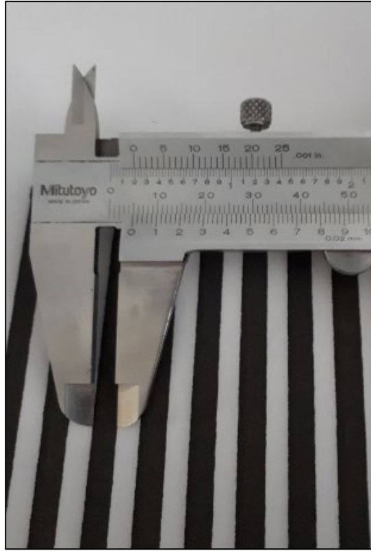
Şekil 5.3. Tetikleme ekseninde çizgilerden ölçü alınması.
