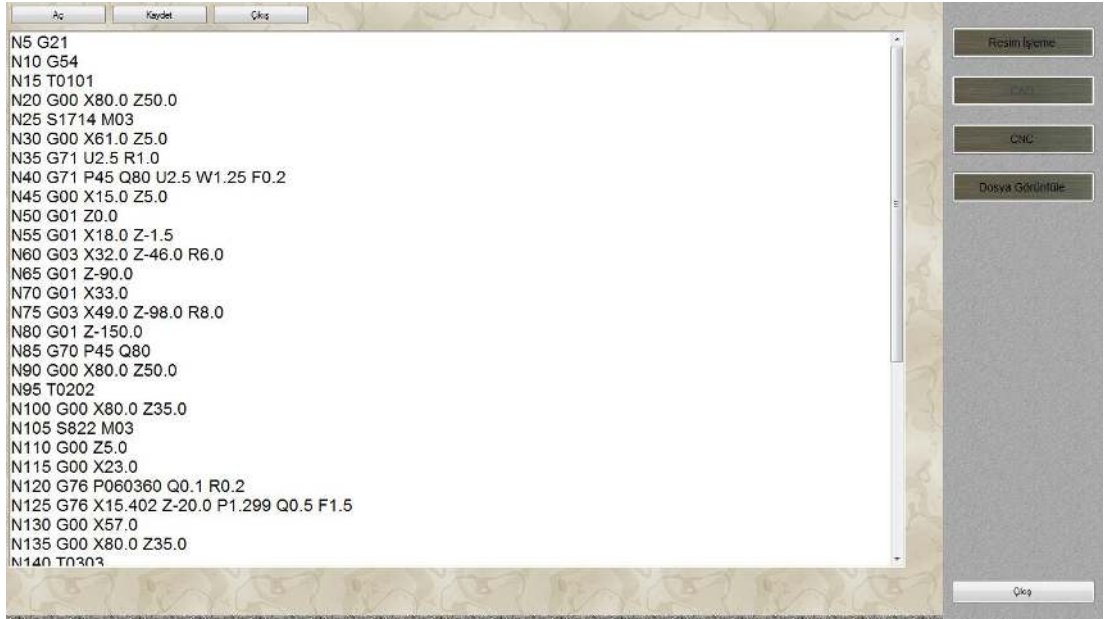
Şekil 8.54. Türetilen CNC kodu
