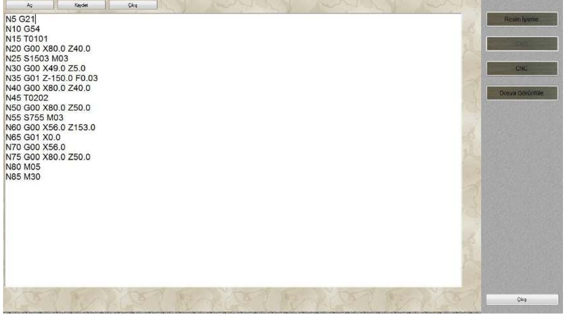
Şekil 1.7. İş parça için türetilen CNC programı
