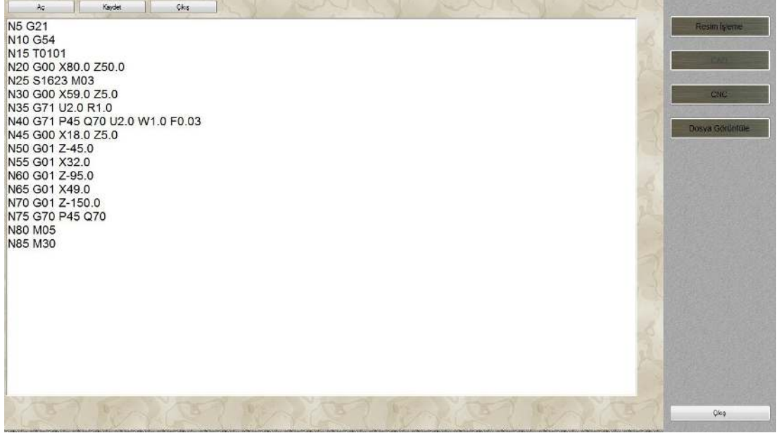
Şekil 2.15. Tanımlanan parça için türetilen CNC programı
