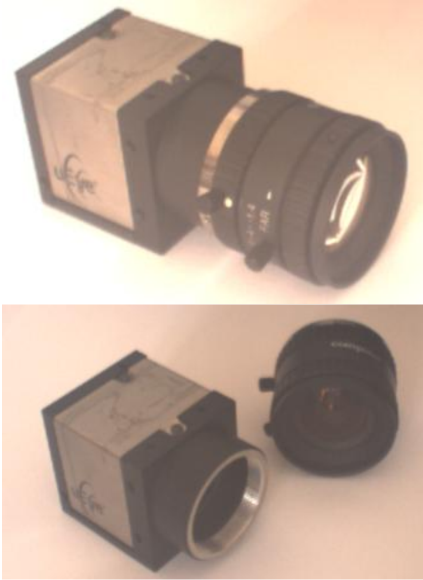
Şekil 7.5. Ueye marka UI-2210-C model kamera
