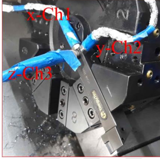
Şekil 3.19. MTJNR 2525 M1604 takım tutucuya ivmeölçerlerin bağlanması.
