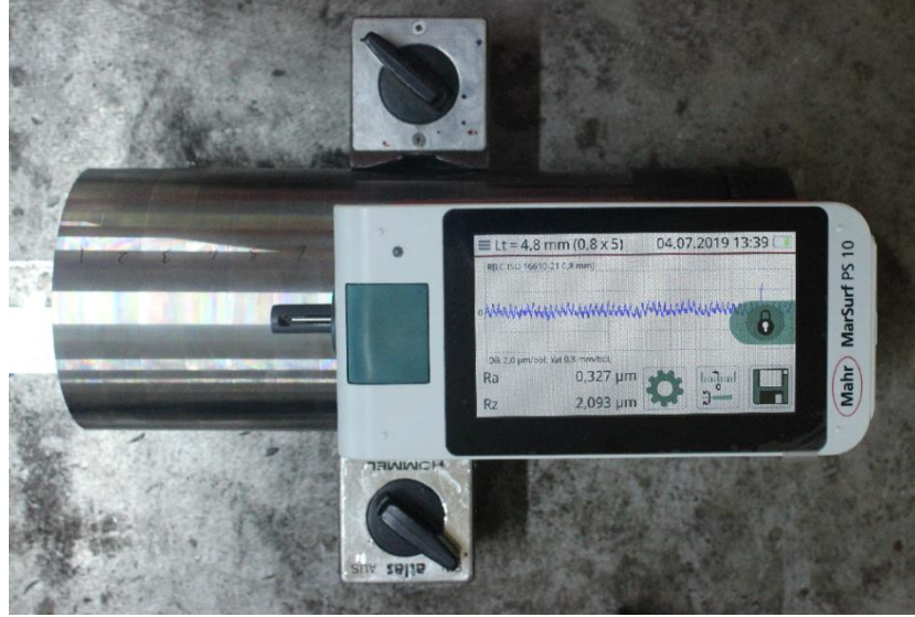
Şekil 3.23. Mahr marka MarSurf PS 10 model ölçüm cihazı ile yapılan ölçüm.
