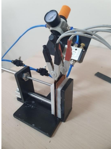
Resim 4.14 Elektriksel iletkenliđin ölçölmesi için hazırlanan deney düzeneđi.
