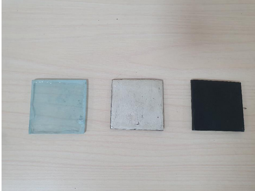
Resim 4.19 Sırasıyla %60 epoksi reçine ve %40 reçine sertleştirici karışımı ile hazırlanmış numune, %1 CNT ve %0.5 nanokil içeren gümüş boya ile kaplanmış numune ve %1 CNT ve %0.5 nanokil içeren numune.
