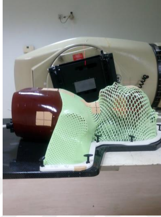
Şekil 3.25. Co-60 teleterapi cihazında rando fantom ışıması (A.Ü)
