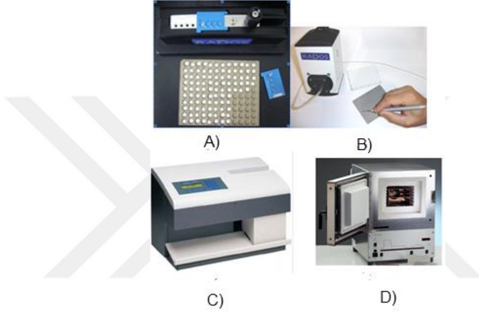
Şekil 3.7. A) TLD fırın tepsisi, TLD ve kaset, B) TLD’lerin metal tepsiye yerleştirilmesi, C) RADOS 2000 TLD okuyucu, D) PTW-TLDO (Termoluminesans dozimetre fırını) E) TLD fırın ısıtma şemaları
