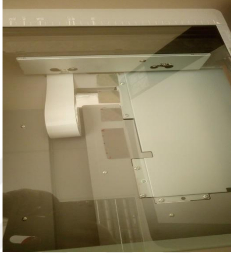
Şekil 3.26. Işınlanan EBT3 gafkromik filmlerin taranması
