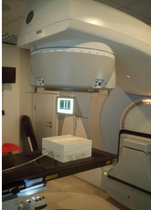
Şekil 3.21. Lineer hızlandırıcı cihazında doz kalite kontrol testi (A.Ü)
