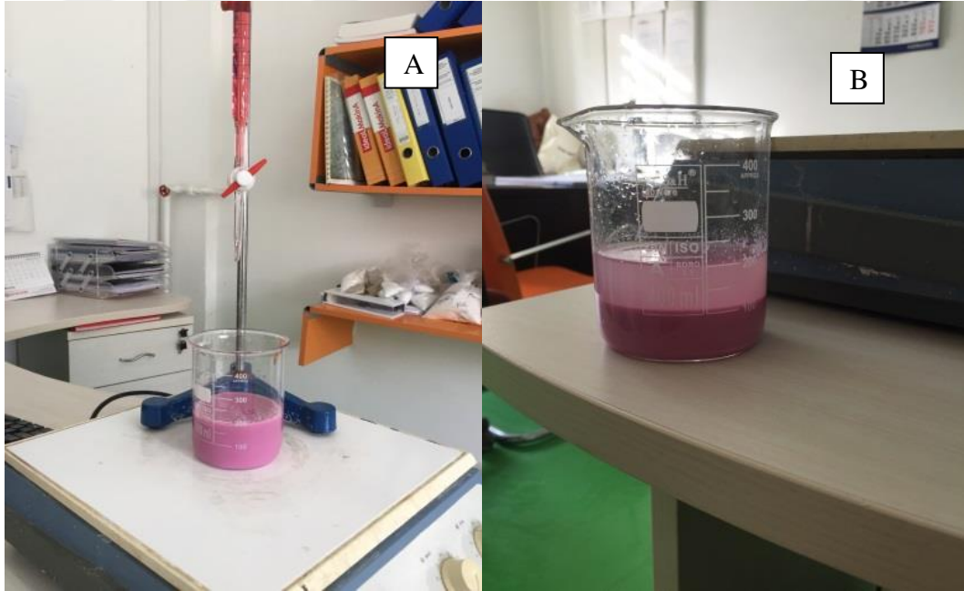
Şekil 4.6. Kobalt borat sentez deney görüntüleri - Tepkime aşaması (A: tepkime aşaması çözelti renk değişimi, B: tepkime sonrası çökelek oluşumu)
