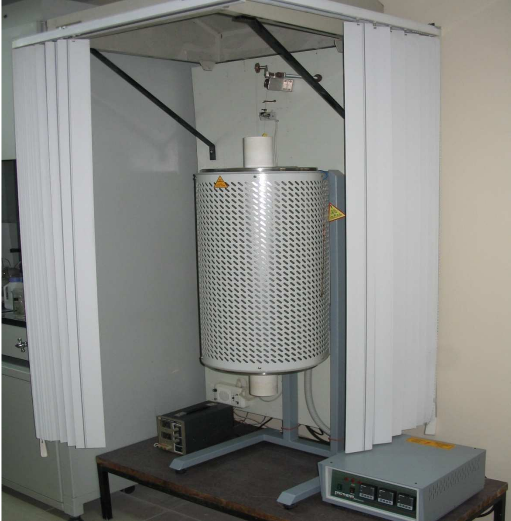
Şekil 12. Üç bölge dikey fırın (Protherm)
