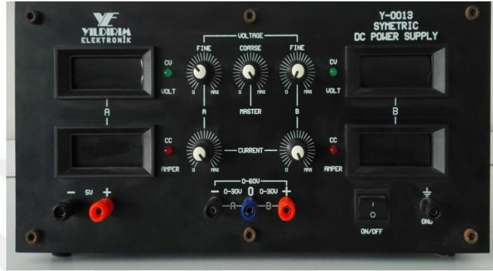
Resim 3. 2 Deneylerde kullanılan doğru akım kaynağı.
