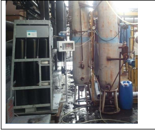
Resim 3.5. Pilot tesis ekipmanları (CO 2 tüp ünitesi ve terazi)
