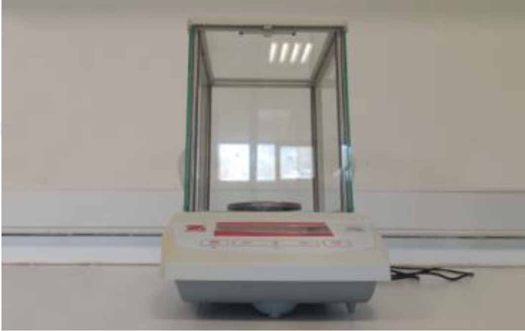
Şekil 2.4. 0,0001 gram hassasiyetinde PA214C model Ohaus Pioneer marka hassas terazi
