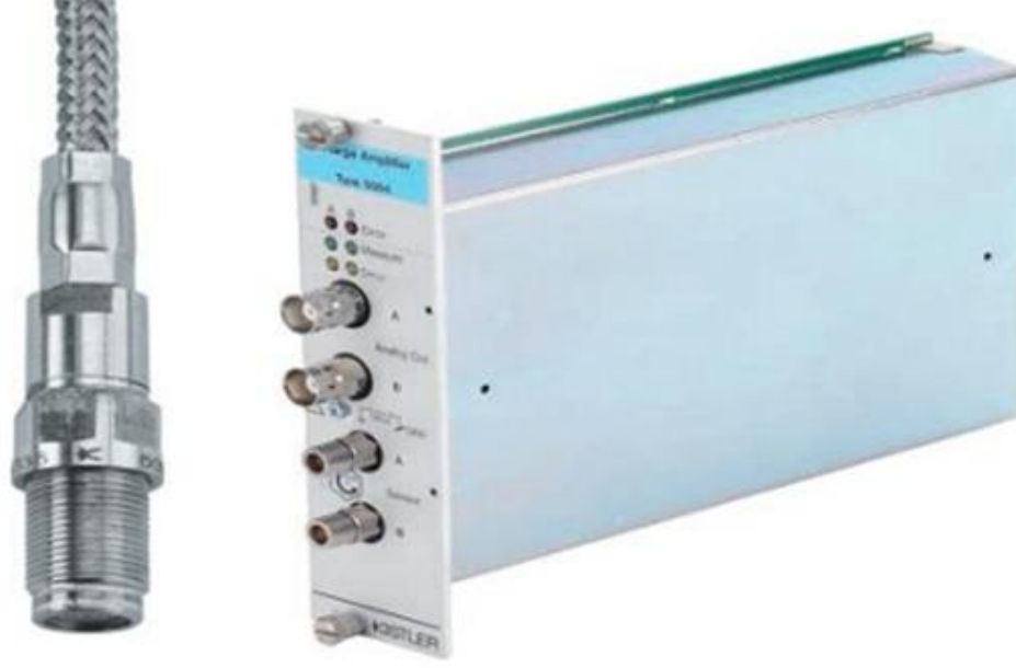
Şekil 2.13. Kistler marka A3 6052C modeli ile silindir basıncını ölçen piezoelektrik basınç sensörü ve 5064 modeli ile sensörü desteklemek için şarj amplifikatörü
