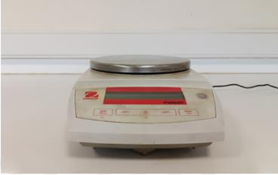
Şekil 2.5. 0,01 gram hassasiyetinde PA4102 model Ohaus Pioneer marka hassas terazi
