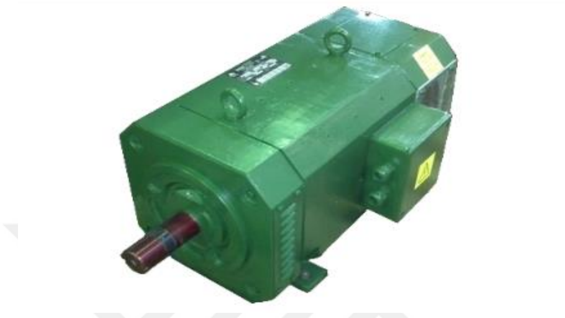
Şekil 2.11. Deney düzeneğinde motor yükünü ve frenlemeyi ayarlayan Kemsan marka dinamometre
