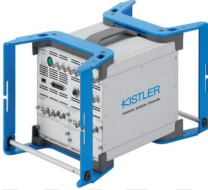
Şekil 2.18. Kistler KiBox veri toplama cihazı
