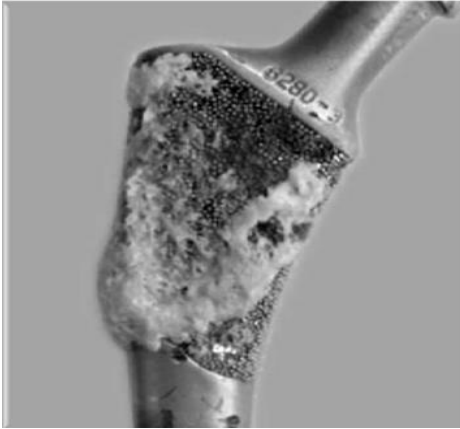
Şekil 3.2. Kalça protezi bağlantı yüzeyinde kemik dokusunun ilerleyişi (Navarro ve ark., 2008).
