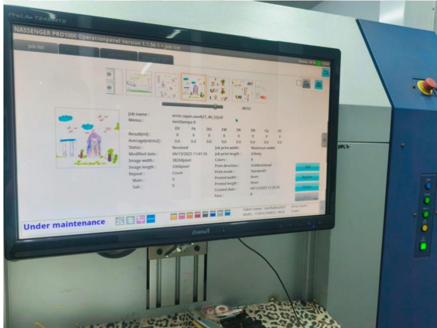
Şekil 70. Tasarlanmış kumaşın dijital baskı makinası kontrol ekranında baskı öncesi incelenmesi işlemi
