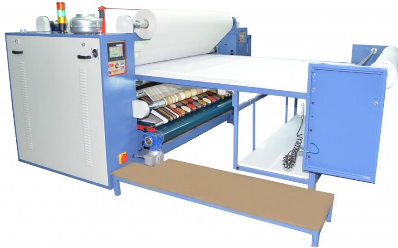
Şekil 14. Parça & metraj kumaş kâğıt transfer baskı sublimasyon kalender makinesi
