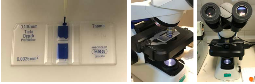
Şekil 3-6: Thoma lamı üzerinde hücre sayımının ışık mikroskobu ile yapılması
