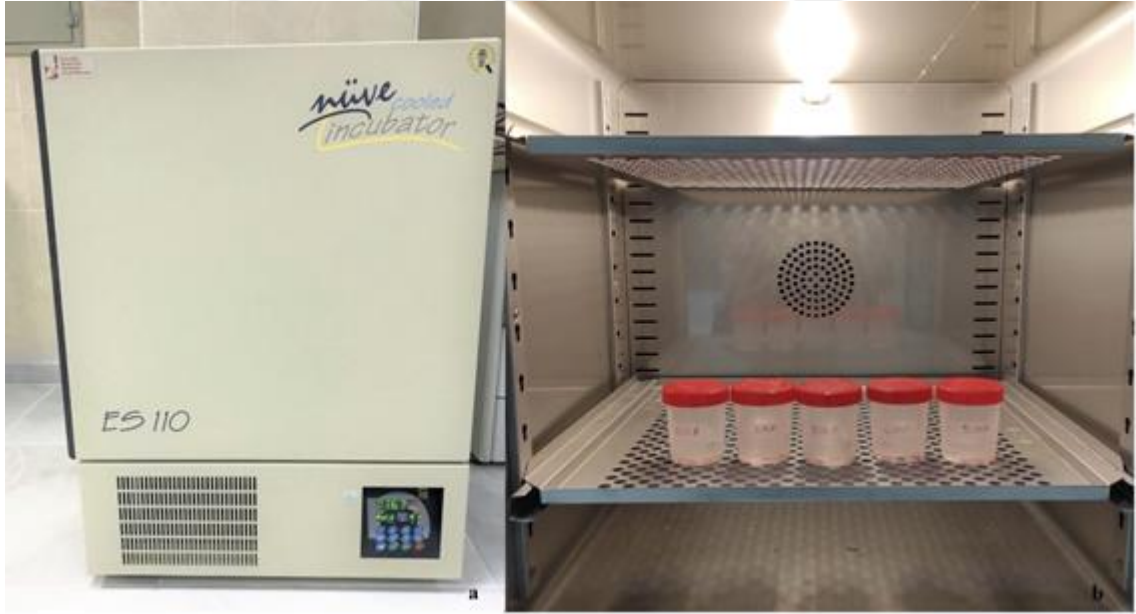
Şekil 3.8. a) Nüve cooled inkübatör ES 110 (Nüve, Ankara, Türkiye) b) İnkübatörde bekletilen örnekler
